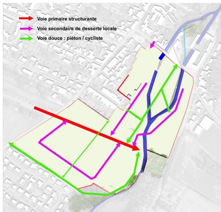
La voie primaire structurante sera conçue de façon à irriguer l'ensemble du terrain à aménager. Elle sera positionnée dans le prolongement de l'axe de la rue de la Basse Selle permettant une vue sur la Selle.
